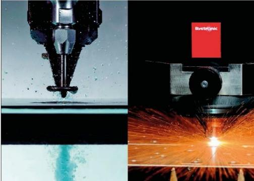
WASSERSTRAHL- UND LASERSCHNEIDEN
